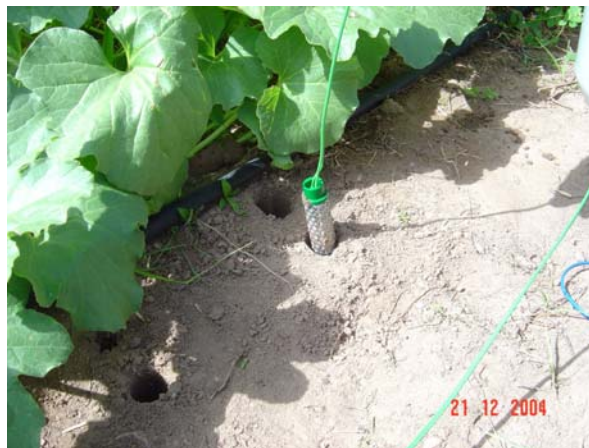
Figura 1. Instalação de sensor de umidade de solo.
